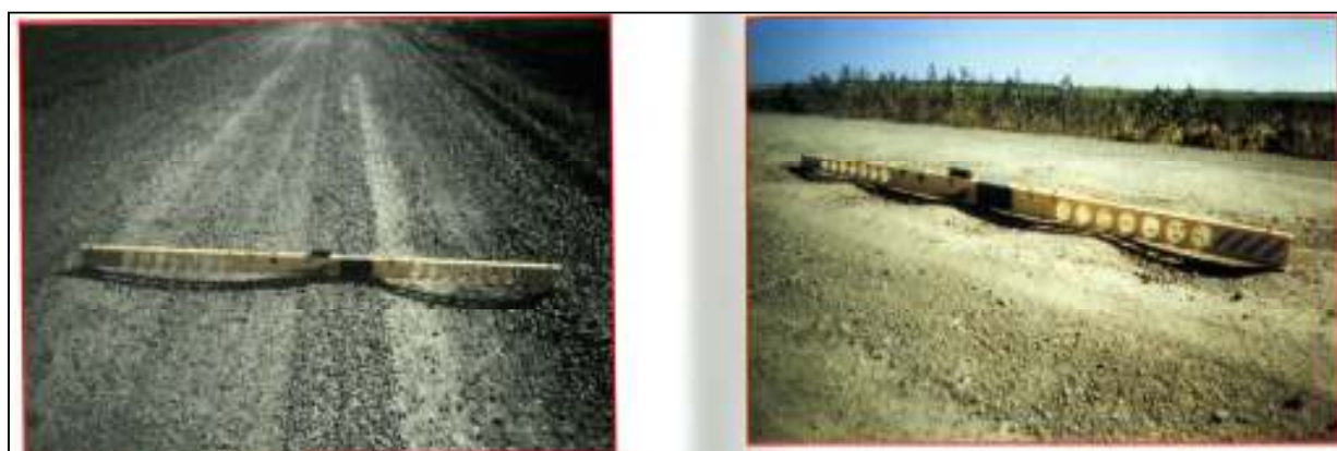
Рис. 2. Определение ровности покрытия проезжей части при помощи 3-х метровой рейки
